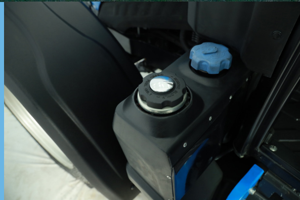
Depósitos de combustible y Adblue
